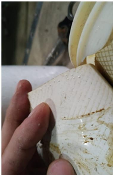
**Рисунок 6. Фото образцов мембран после испытаний без применения ПЗО**
