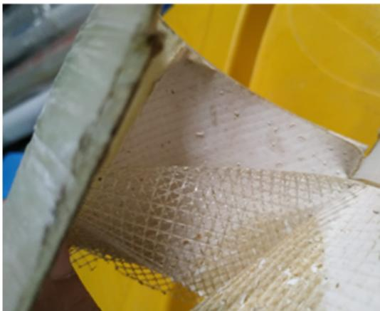
**Рисунок 5. Фото образцов мембран после испытаний с применением ПЗО**
