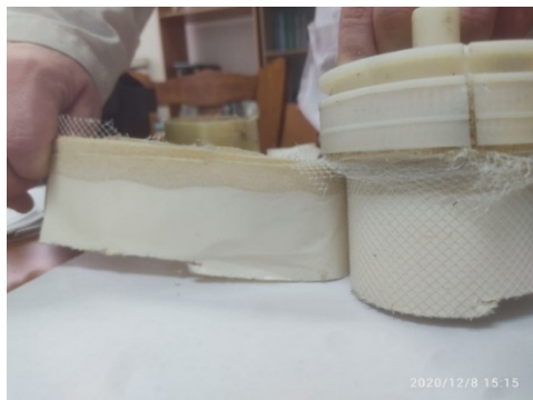
Рисунок 9 – Фотографии разрезанных мембран: а) с применением магнитной обработки воды; б) без применения магнитной обработки воды
