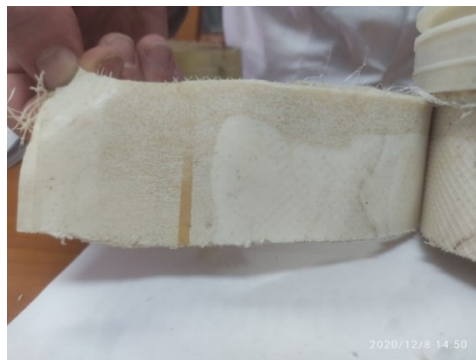
Рисунок 9 – Фотографии разрезанных мембран: а) с применением магнитной обработки воды; б) без применения магнитной обработки воды
