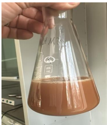
Рисунок 3 – Осаждение кутина 6М соляной кислотой
