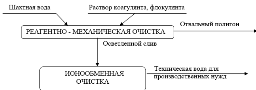
Рисунок 7 – Принципиальная технологическая схема получения технической воды с использованием методов ионного обмена.
