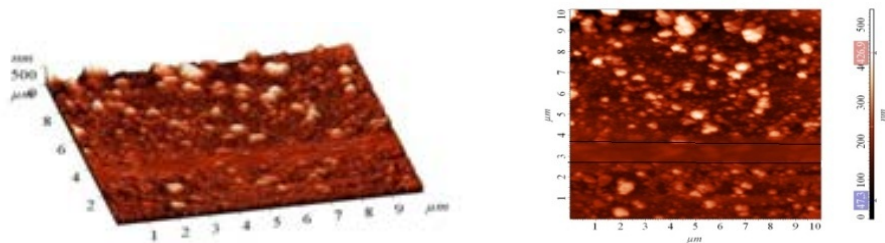
Рисунок 2 – АСМ изображения участков поверхности композиционной пленки ПИ:ПАНи.
