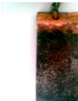
6-сурет – Графит ұнтағы енгізіліп, фосфинқұрамды газбен өңделген үлгі
