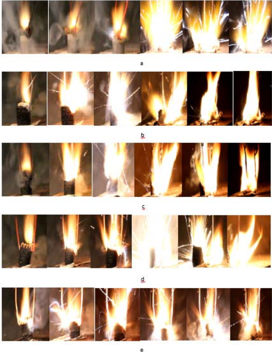
Figure 1 – Burning of pyrotechnic compositions: a) AN/Mg/Nlac, b) AN/Mg/Activated carbon(FeO-2%)/Nlac, c) AN/Mg/Activated carbon(FeO-5%)/Nlac, d) AN/Mg/Activated carbon(NiO-2%)/Nlac, e) AN/Mg/Activated carbon(NiO-5%)/Nlac
