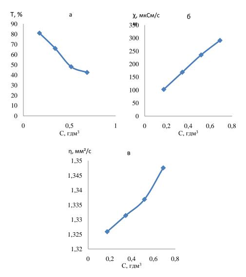
Зависимости коэффициента пропускания (а), электропроводности (б) и кинематической вязкости (в) от концентрации сапропеля а: l=10 см,  $\lambda=490$  нм
