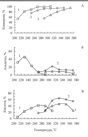
Мольное отношение 3-метилпиридин: $O_2$ : $H_2O=1$ :14:110,0:  $1-V_2O_5$ ·4Ti $O_2$ ,  $2-2V_2O_5$ · $Cr_2O_3$ ,  $3-2V_2O_5$ ·4Ti $O_2$ · $Cr_2O_3$ .
