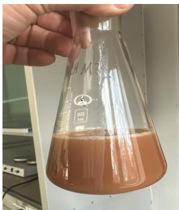
Рисунок 3 – Осаждение кутина 6М соляной кислотой
