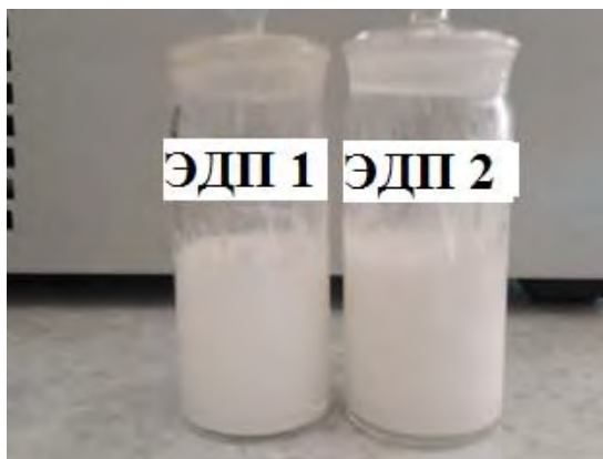
Рисунок 1 – Фотоснимок депрессорных присадок эмульсионного типа, полученных после оптимизации синтеза.
