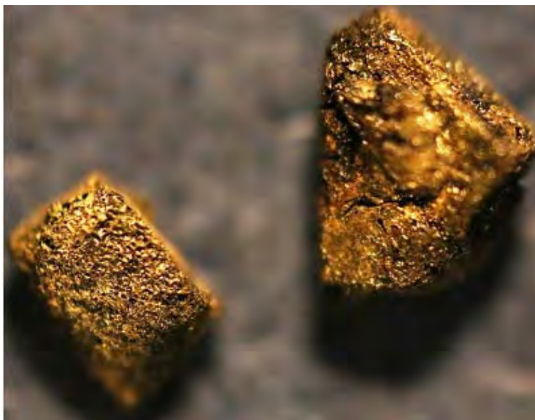
1-сурет – Алтынның сорбциялау процесінен кейін өрік қабығының негізінде активті көмірдің беттігінің фотосуреті
