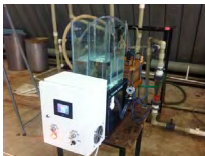
Рисунок 2 – Пилотная электродиализная установка производительностью 50 л/ч и фотографии образцов синтезированных интерполимерных мембран
